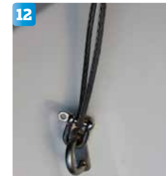
12 Linan splitsas och sätts fast i ett schackel i ögla på akterspegelns babordssida. Likadant görs på styrbordssidan.
