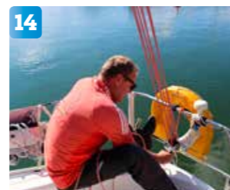
14 Spärrblocket med cleat monteras fast i en befintlig vajerstump. För att få upp blocket från däck behövs bara om sittbrunnssargen är hög.
