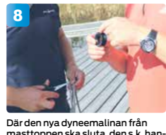
8 Där den nya dyneemalinan från masttoppen ska sluta, den s.k. hanfotshöjden, är det drygt tre meter ovanför sittbrunnen. Där splitsas det fast en 21-millimeters ledning som fördelar akterstagssträckarens övriga linor som skapar de första två utväxlingarna. Ytterligare en ledning ska användas. (se bild 11)
