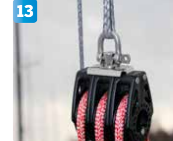
13 En av de gråa linorna från ledningen splitsas och fäst i ett schackel som i sin tur skruvas fast i trippelblocket.
