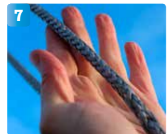
7 Nya fräscha dyneemalinor 7 millimeter i grå kulör ska dras ner från masttoppen. Det är den gamla vajerns diameter plus 1 mm.
