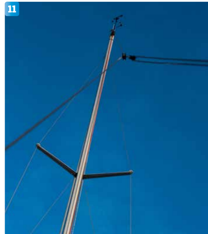
11 Så här ser det ut när de gråa dyneemalinorna från de två splitsade ledningarna hänger på plats. Genom den översta ledningen löper en annan dyneemalina upp från en ögla, fastsatt på akterspegelns babordssida. Den lina avslutas med den andra splitsade ledningen som i sin tur fördelar två linor åt styrbordssidan. Den ena av de två linorna går till ett nytt trippelblock som ersätter det gamla fiolblocket, och den andra lina löper till en ögla på akterspegelns styrbordssida.
