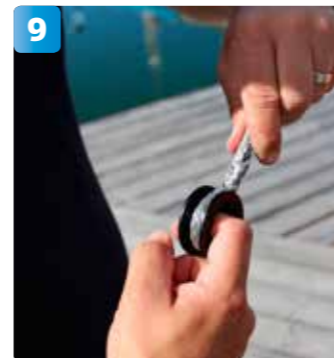
9 Så här blir resultatet av splitsningen runt en av de två ledningarna.
