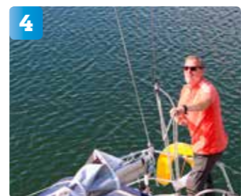
4 Mats tar bort akterstagssträckarens linor och vajrar som sträcker sig upp mot masttoppen. Akterstaget har ingen funktion för att hålla masten på plats.
