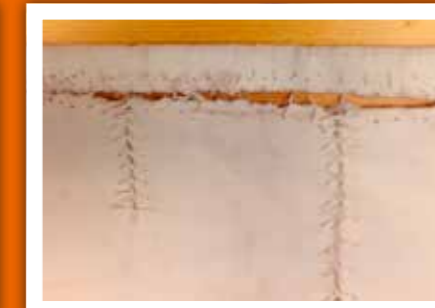
Dacron med crosscut. Uppskattningsvis tillverkad för 15 år sedan. Vid akterliket finns en rejäl reva som ska repareras med nya mindre paneler.
