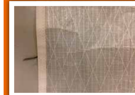
Cruisinglaminat i radiell skärning. Drygt tio år gammalt. Formen har blivit sämre och det har blivit veck på duken.
