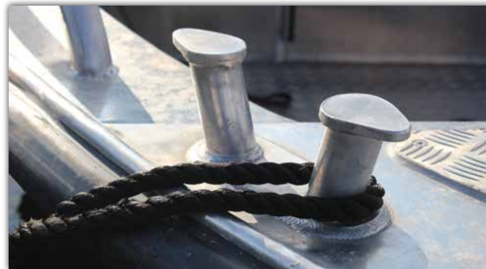
De bastanta pollarna av aluminium är fastsvetsade.
