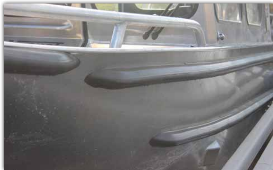
Skrovsidorna är utrustade med kraftiga avbärgarlistor av gummi.
