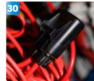
30 En säkringshållare för pumpen kopplas också in.
