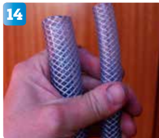
14 För att montera ihop systemet används PVC-slangar i två olika dimensioner. Den tunnare på 13 millimeter ska gå från kranen till tryckvattenpumpen. Den tjockare på 19 millimeter ska löpa från pumpen till sjövatteintaget.
