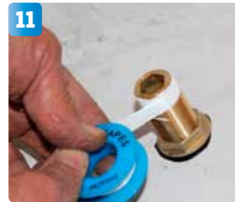
11 Efter några dagar, då massan har torkat ordentligt, kan monteringen fortsätta. Bob börjar med att linda gängtejp på skrovgenomföringen.
