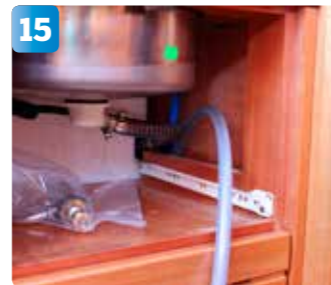
15 Bob börjar med att dra en 13 millimeters-slang mellan diskhon och stuvutrymme där tryckvattenpumpen ska monteras.
